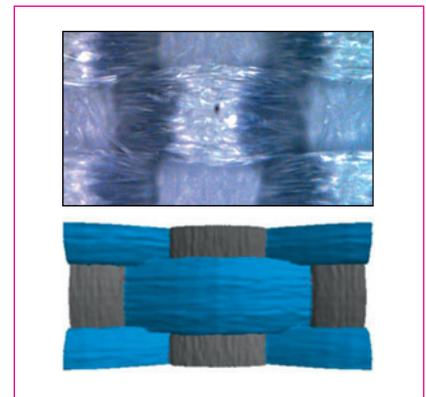
Abb. 1: Draufsicht eines realen (oben) und generierten (unten) multifilen Gewebes
